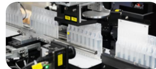
針對生技藥廠，宇瞻具有開發適用於各種類型、尺寸容器的自動化檢測機台實力，包括點滴瓶、枕式瓶、粉針瓶、安瓿瓶...等，不論是瓶罐的外觀瑕疵、內部異物亦或是液位高度，皆可快速且有效的檢出瑕疵。目前實際應用的案例中，已成功為藥廠減少逾五成的檢測人力。
